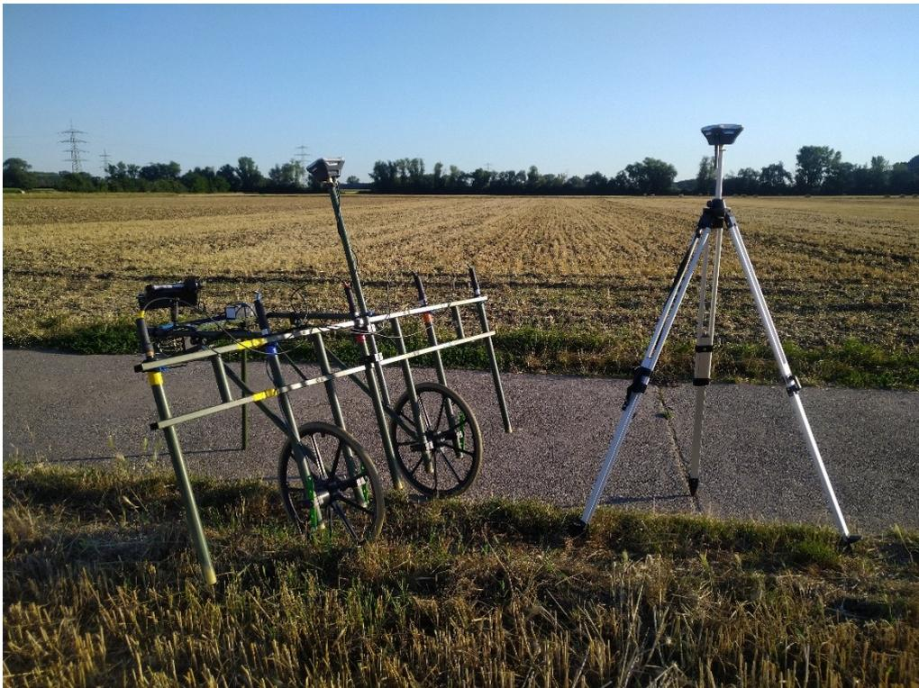
Abbildung 2 Die Ausrüstung: Messwagen (links) und GPS-Basisstation (rechts).
