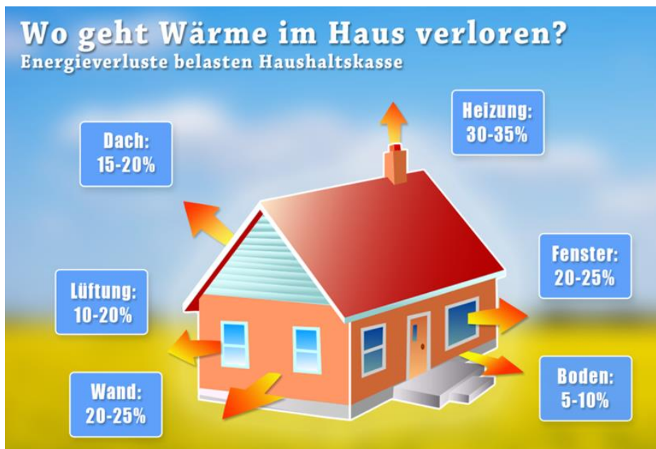
Abbildung 17: Energieverluste bei der Wärmeversorgung bestehender Wohngebäude 13
